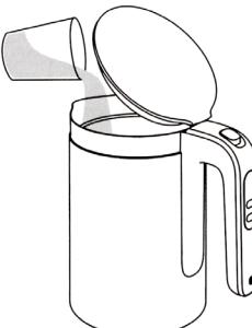
1. Налейте в чайник 0.5 литра столового уксуса в чайник, и не включая чайник, оставьте на один час.
