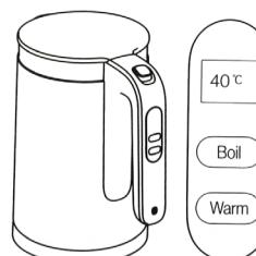
1. Для наполнения водой возьмите чайник с базы, откройте крышку нажатием кнопки на верхней части ручки, и наберите нужное количество воды. Всегда наполняйте чайник объёмом от 0.5 до 1.5 литров воды. Слишком маленькое количество воды вызовет выключение чайника до закипания
