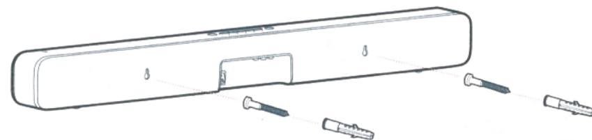
Просверлите на основе поставленных точек два отверстия в стене, в зависимости от типа вашей стены сложно процедуру может меняться.
