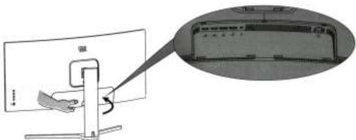
7. Снимите заднюю крышку подставки, установите все провода, после чего закройте обе крышки.
