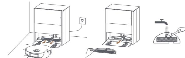
**Примечание.** Модуль нагрева под промывочной панелью промывочную панель. Во избежание ожога соблюдайте осторожность при снятии фильтра промывочной панели.
