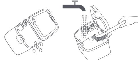
**Примечание.** Поплавковый уровнемер в баке для отработанной воды является подвижной деталью. Чистите уровнемер без чрезмерных усилий, чтобы не повредить его.
