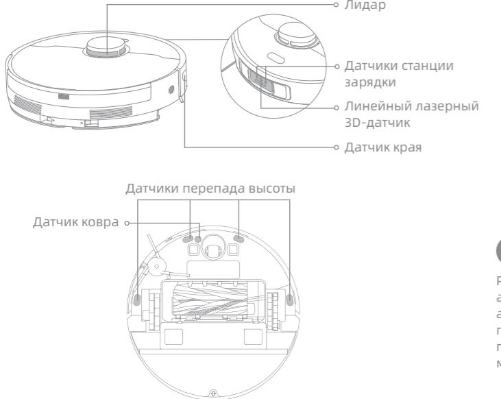
**Примечание.** Влажное полотенце может повредить чувствительные элементы робота и базы для зарядки. Для очистки используйте только сухую ткань.
