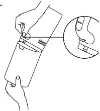
2. Достаньте фильтр и циклонный блок из контейнера для пыли, а затем удалите содержимое контейнера.
