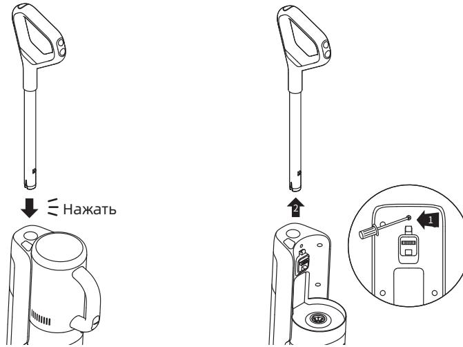
Примечание: Чтобы снять ручку, нажмите на контакт в отверстии задней части пылесоса и одновременно потяните ручку вверх.
