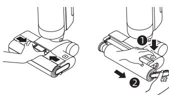
2. Удалите волосы и загрязнения, запутавшиеся в роликовой щетке, с помощью чистящей щетки в комплекте. Промойте роликовую щетку чистой водой и тщательно просушите ее.
