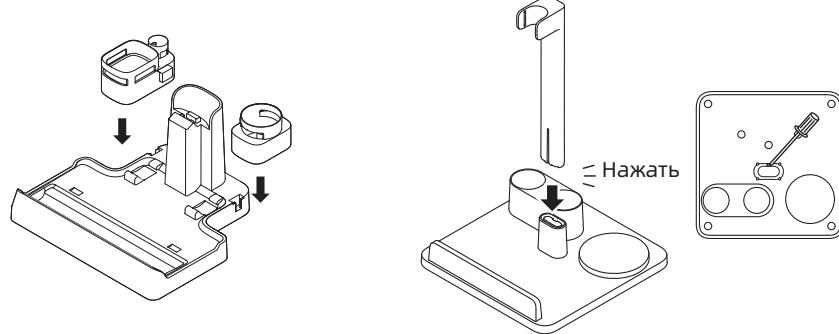
Примечание: Чтобы удалить опорный стержень, вытяните инструмент в отверстие в нижней части крепления, чтобы прижать контакты и одновременно потянуть стержень вверх.
