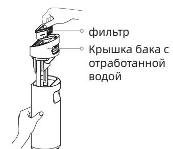
3. Ополосните бак с отработанной водой и крышку чистой водой. Очистите внутренние стенки бака с помощью чистящей щетки в комплекте.
